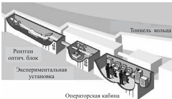
Рис. 3.1. Схематическое изображение оборудования канала синхротронного излучения с пультом управления и экспериментальной установкой
