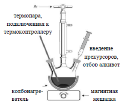
Рис.2. Схема установки для синтеза КТ.
