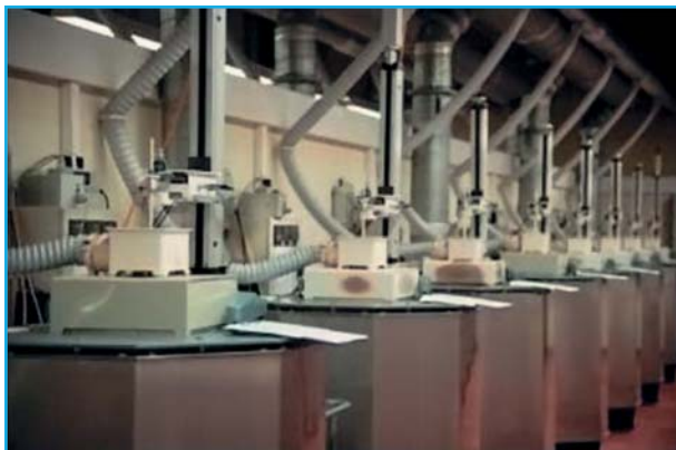
◀ Рис. 4.26. Производственный цех с 86 установками для синтеза кристаллов RTP, KTP и LBO компании CRISTAL LASER S.A. (Франция)
