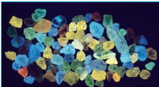
◀ Рис. 3.2. Необработанные алмазы имеют разные цвета флуоресценции при исследовании их под ультрафиолетовым светом
