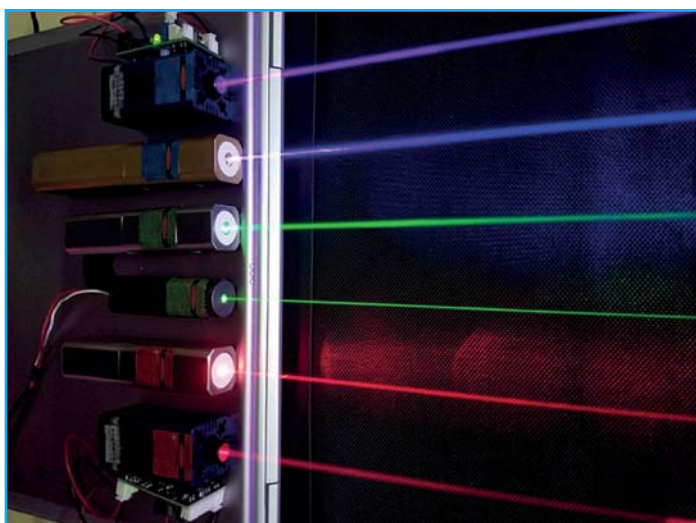
▲ Рис. 4.16. Полупроводниковые лазеры, генерирующие световые волны разной длины (снизу вверх: 660 нм, 635 нм, 532 нм, 520 нм, 445 нм, 405 нм)
