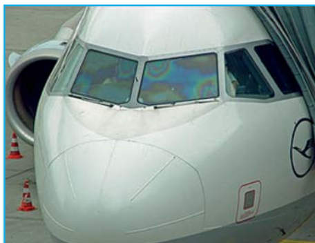
▲ Рис. 8.14. Интерференция световых волн на тонких пленках ИТО, покрывающих незамерзающие окна кабины пилотов в самолетах Airbus
