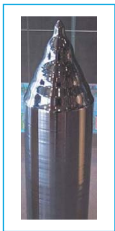
▲ Рис. 8.1. Монокристаллический кремний, выращенный по методу Чохральского, – полупроводник, наиболее широко используемый в промышленности
