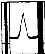
Рис. 3-4. Изучение седиментации методом ультрацентрифугирования (ширрен-оптика).
