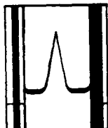
Рис. 3-4. Изучение седиментации методом ультрацентрифугирования (ширрен-оптика).
