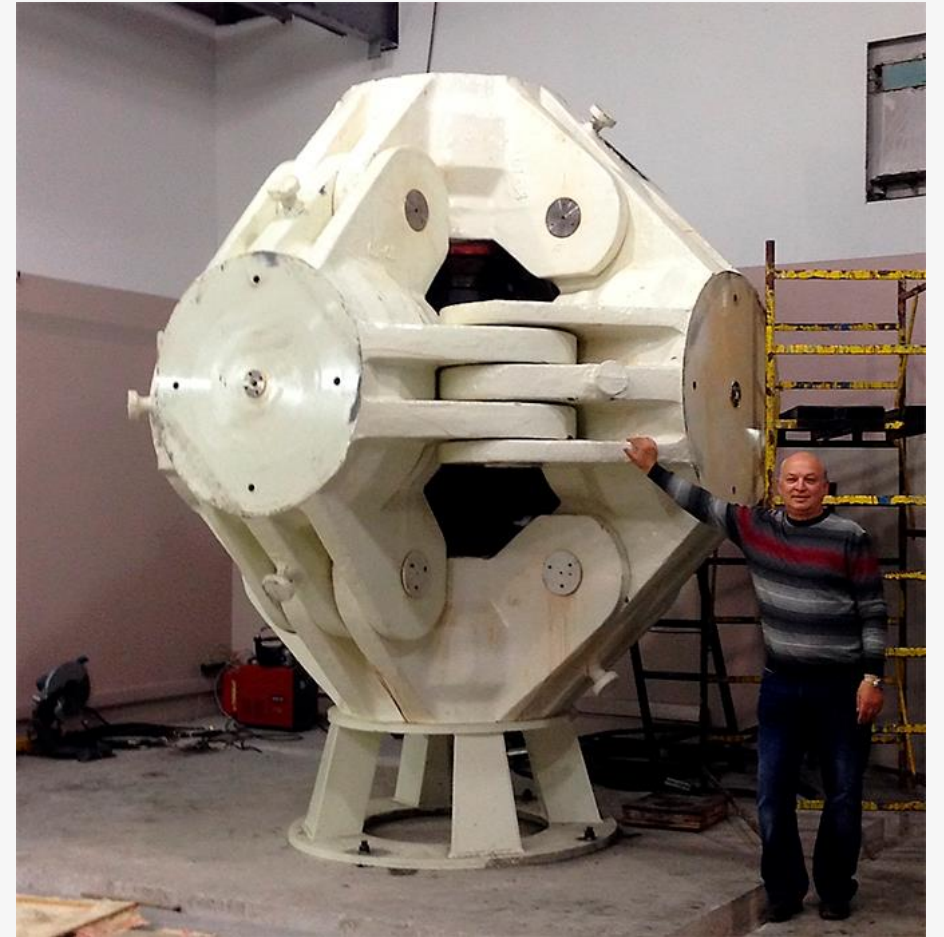
Сборка кубического прессы 850 «Нью Даймонд Технолоджи»
