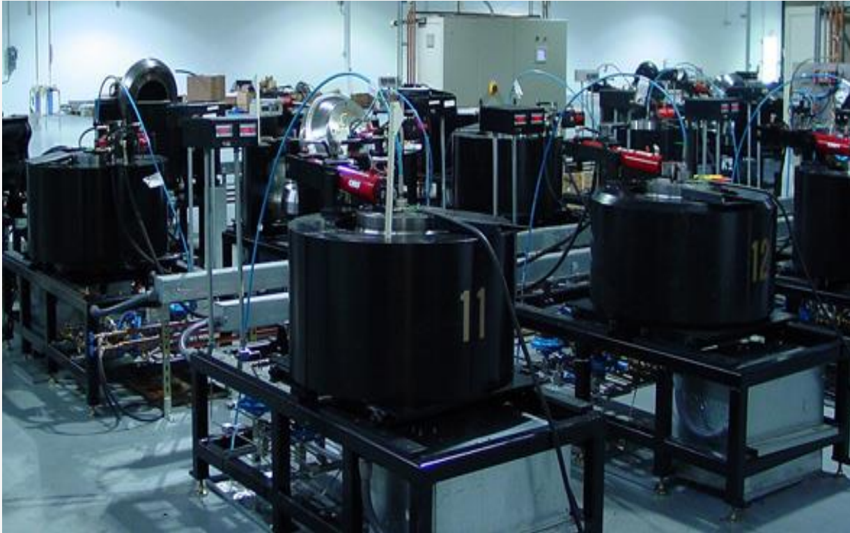
Современное оборудование для синтеза алмазов НРНТ методом (компания «De Beers»)
