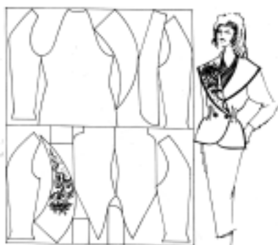
Рис. 7. Двухмодульная раскладка комплекта лекал для женского костюма
