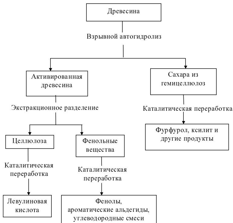
Рис. 7. Схема переработки древесины в ценные химические продукты методом «взрывного» автогидролиза
