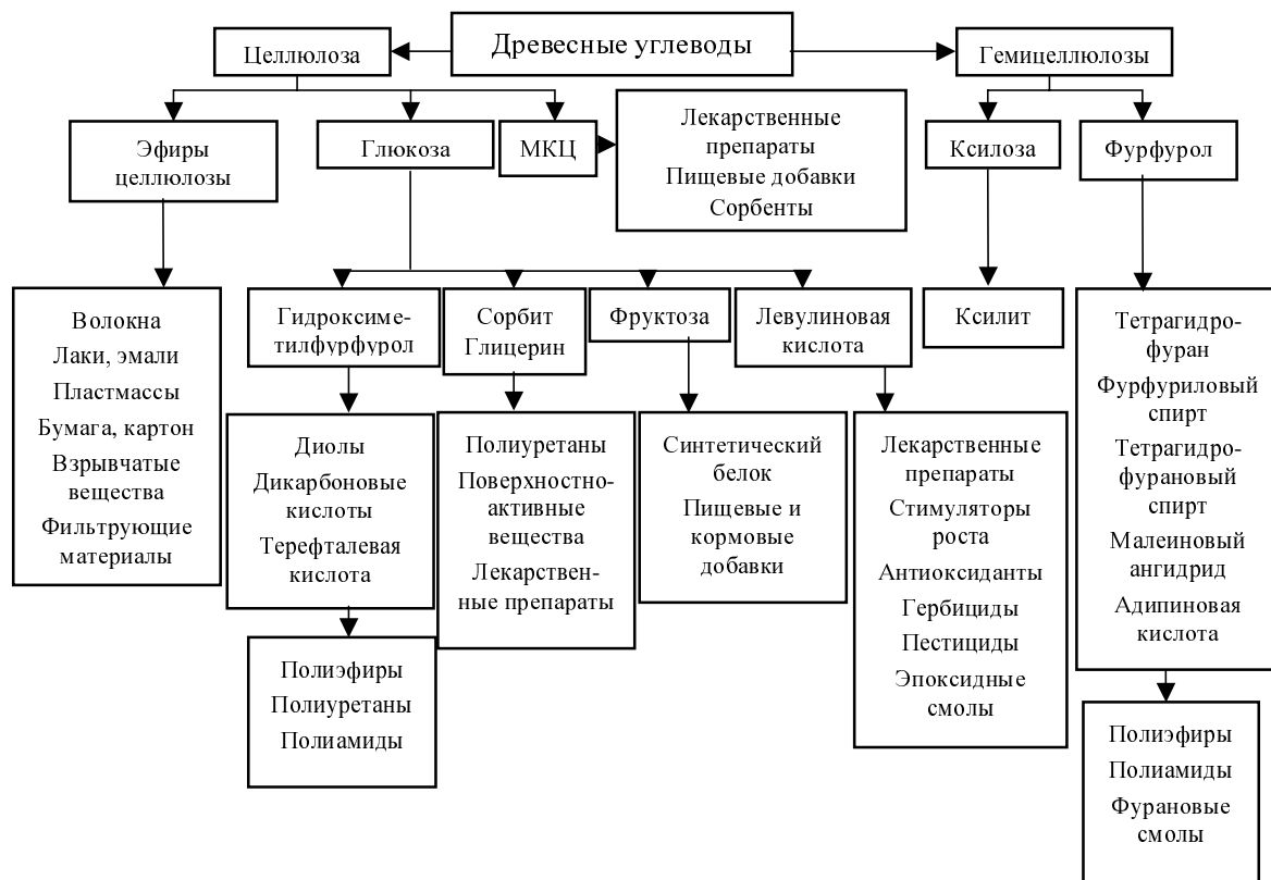
Рис. 3. Возможные пути переработки древесных углеводов в химические продукты
