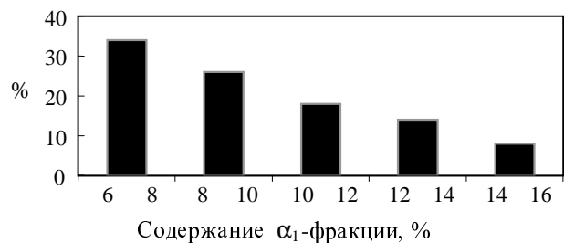
Рис. 5. Доля пеков с различным содержанием \alpha_1 -фракции, используемых в производстве углеродной продукции в мире
