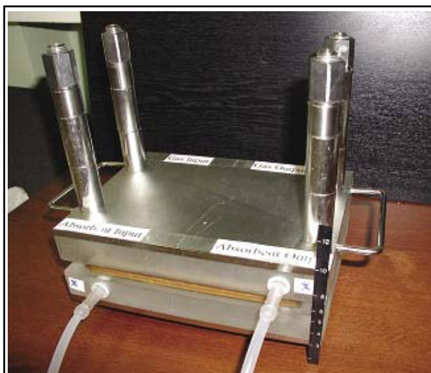
Рис. 3. Внешний вид мембранного контактора (МК) и мембранной кассеты
