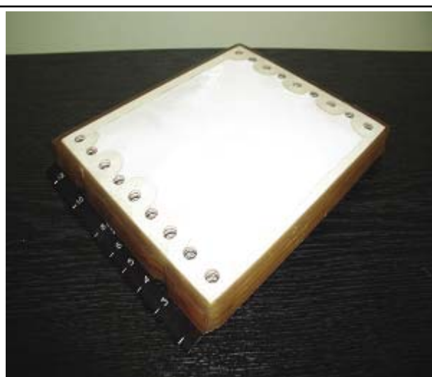
Рис. 3. Внешний вид мембранного контактора (МК) и мембранной кассеты
