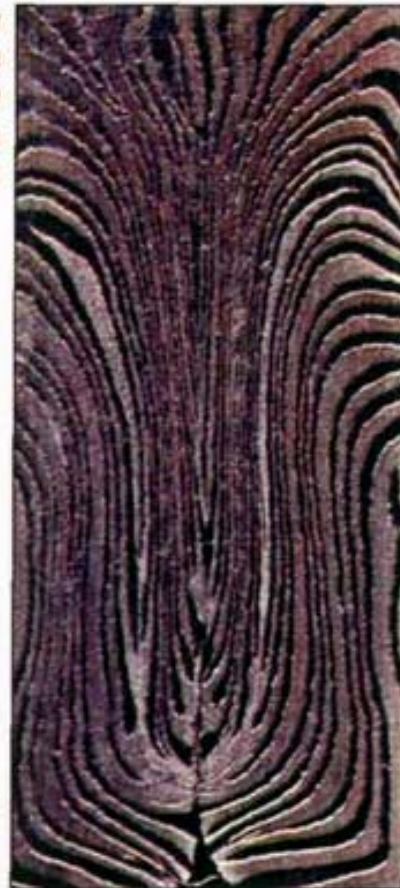
Поперечный разрез заготовки сварного булата клинки
