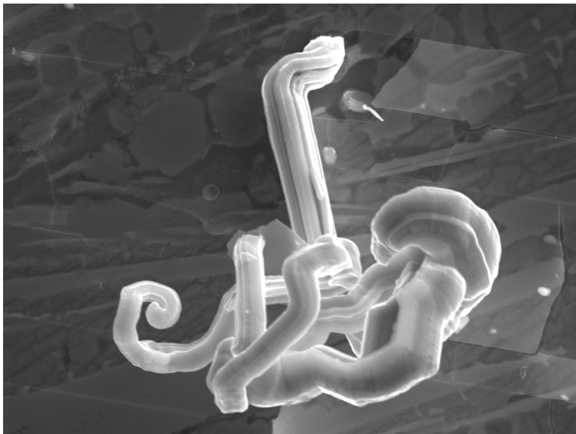
П. 7. Кристаллы индия на поверхности сплава.
