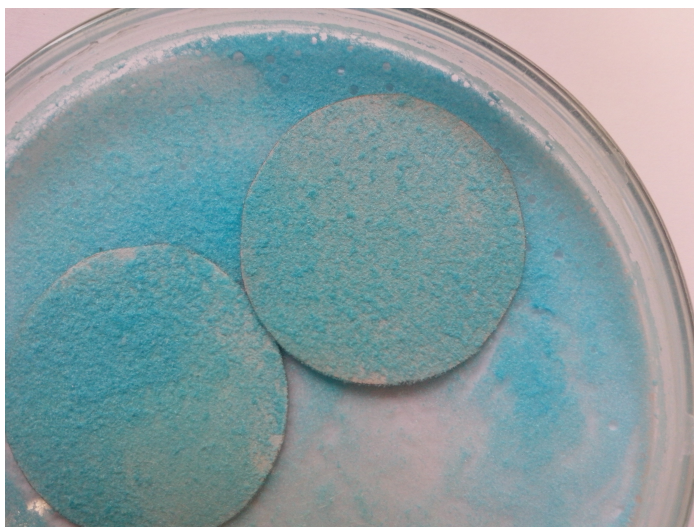
Рис. 3.10. Фотография крупных кристаллов на поверхности МК при вторичном формировании слоя MOF-199.
