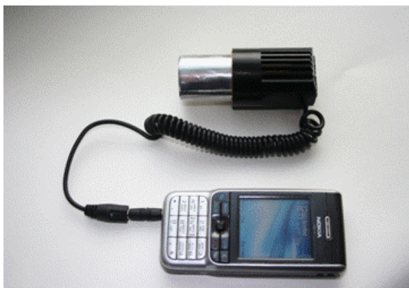
Рисунок 54. Система водородно-воздушный топливный элемент - алюмоводный микрогенератор водорода в качестве источника питания мобильного телефона.
