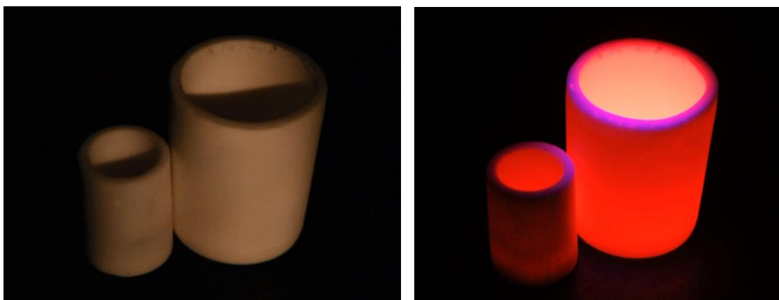
Рисунок 4 - \text{NaEu}(\text{MoO}_4)_2 (слева) и его свечение в УФ ( \lambda_{\text{ex}} = 395 нм) (справа).
