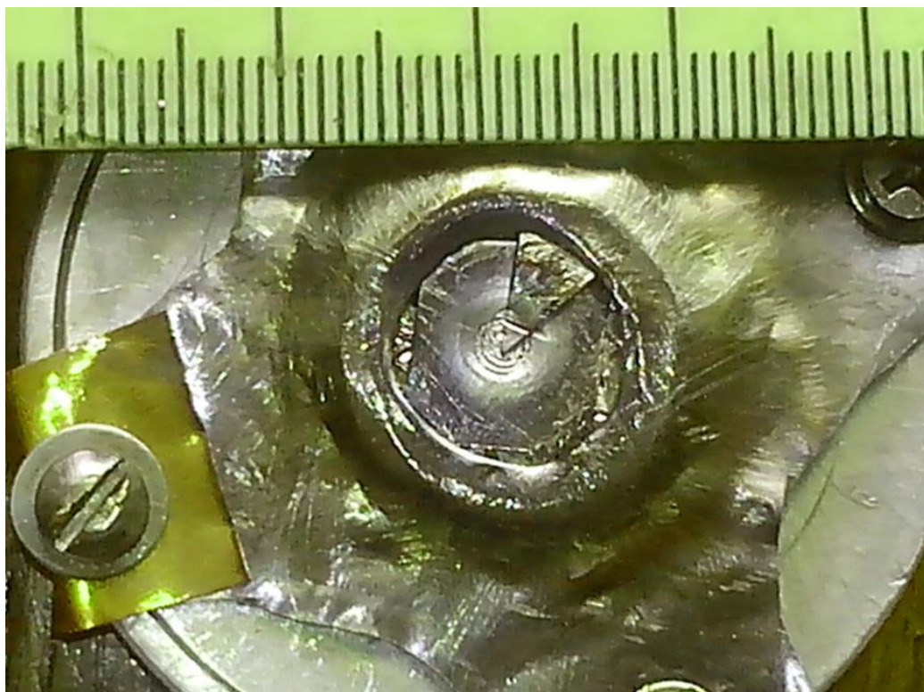
Рис.4.38. Палладий-серебряная секторная мишень с устройством крепления на электродвигателе вращения.
