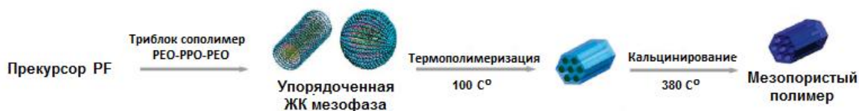
Рис. 4.42. Схема синтеза азотсодержащих мезопористых полимеров на основе фенол-формальдегидных мономеров
