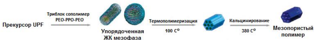
Рис. 4.40. Схема синтеза азотсодержащих мезопористых полимеров на основе фенол-мочевино-формальдегидных мономеров
