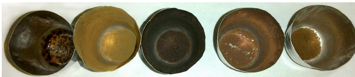
Рис. 14. Вид наноалмазов, выдержанных до полного сгорания при температуре 700^{\circ}\text{C} : сплавленная зола (крайний левый тигель) и нормальная рыхлая легко переносимая зола. Слева направо: RUDDM 3, RUDDM несортированный, УДА-С, УДА-С-ГО, УДАГ-С.
