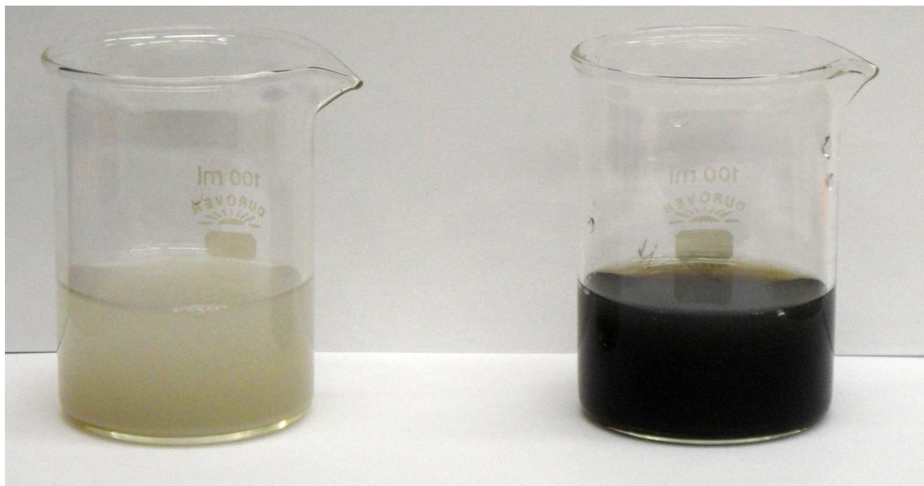
Рис. 43. Промытые и разделенные на две фракции наноалмазы RUDDM (2) после 31 суток обработки HClO 4 по методике 21. Слева — суспензия белого нерастворимого осадка, осевшего при отстаивании («белая фракция»), справа — оставшийся седиментационно-устойчивый коллоидный раствор наноалмазов.
