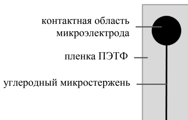
Рис. 14. Схема микроэлектрода, изготовленного методом лазерной абляции.
