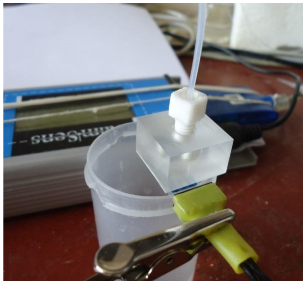
Рис. 74. Фотография модельной проточной тонкослойной ячейки в процессе измерения.
