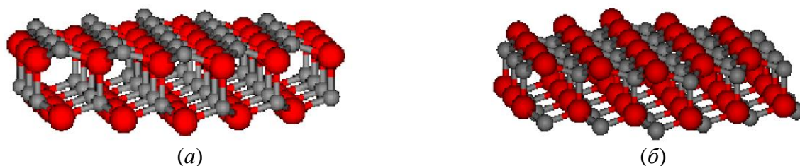
Рис. 12. «Идеальная» структура полярных поверхностей ZnO: (а) – (0001) , (б) – (000\bar{1}) . Атомы Zn представлены серыми сферами, атомы кислорода – красными [38].
