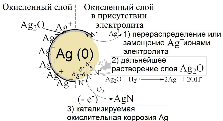
Рисунок 6. Схематическое изображение процессов окисления поверхности наночастиц и растворения слоя оксида [48].
