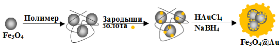
Рис. 23 Схема получения НЧ \text{Fe}_3\text{O}_4@\text{PEI}@\text{Au} [41]
