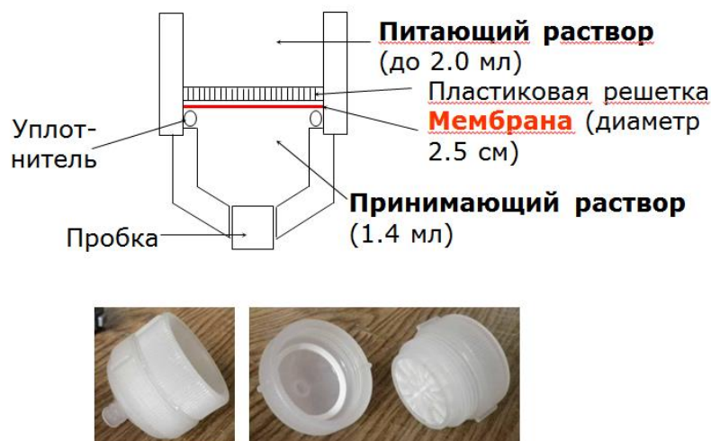
Рис. 13. Схема и фотографии диффузионной ячейки
