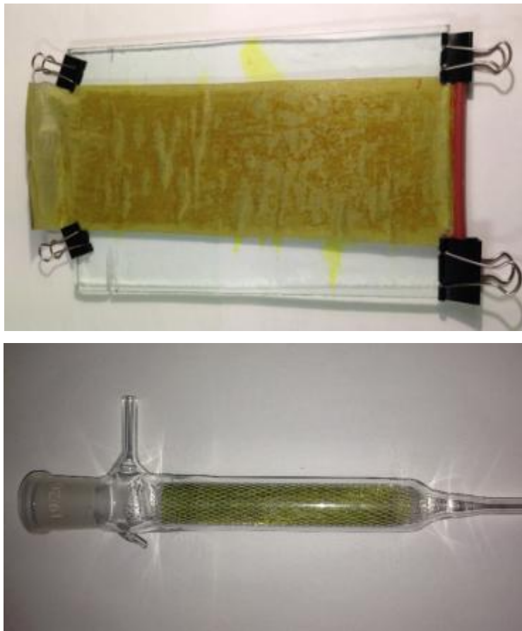
Рисунок 4.8.1. Общий вид образца на основе РИМ-1 с сеткой из нержавеющей стали (верхняя фотография) и сорбент в стеклянном корпусе (нижняя фотография).
