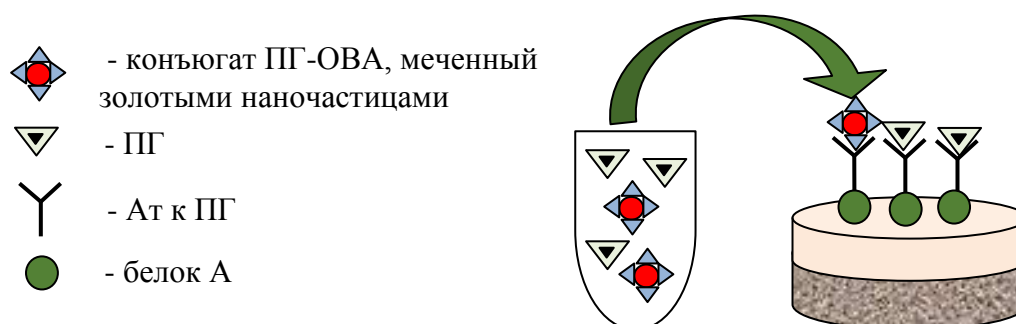
Рис. 49. Схема проведения ИФиА ПГ с коллоидным золотом в качестве метки, где в тестовой зоне иммобилизован белок А.
