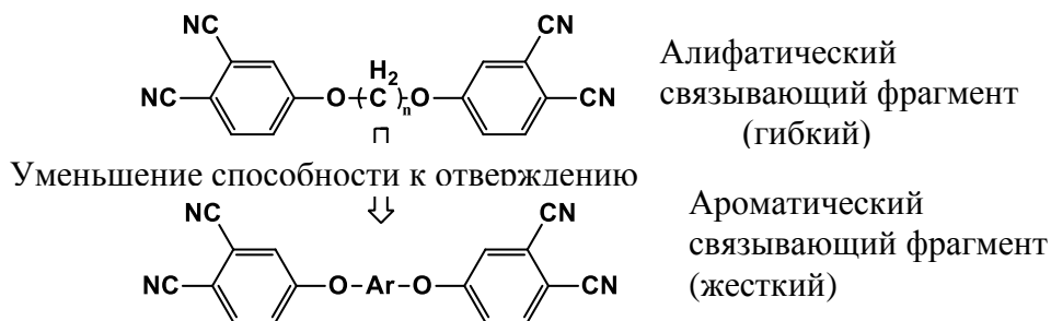
Рисунок 6 – Структуры фталонитрильных мономеров, содержащих алифатические и ароматические связывающие фрагменты
