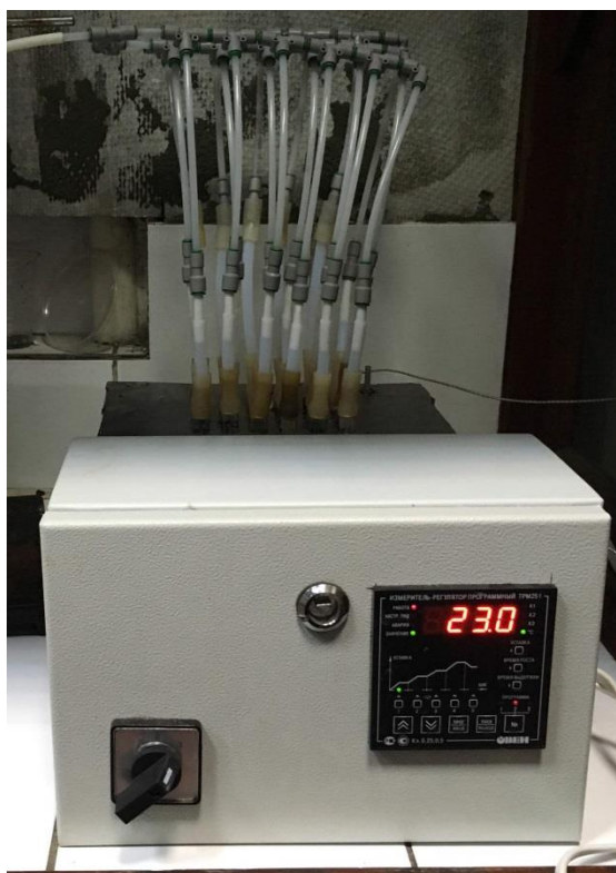
Рисунок 41 – Система для проведения отверждения фталонитрильных связующих в инертной атмосфере
