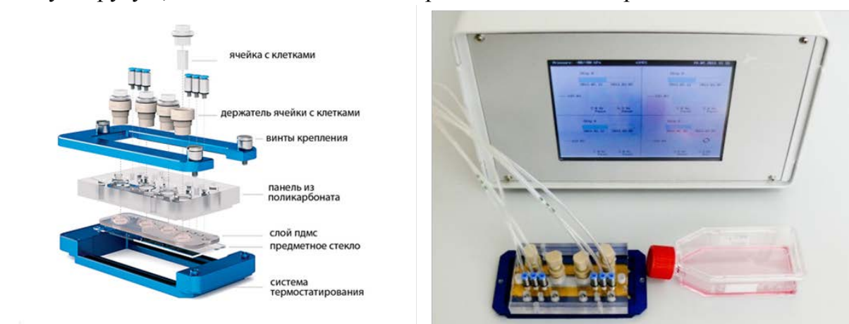
Рис. 2.3.2. Схема устройства биочипа «Гомункулус» (слева) и его внешний вид (справа)
