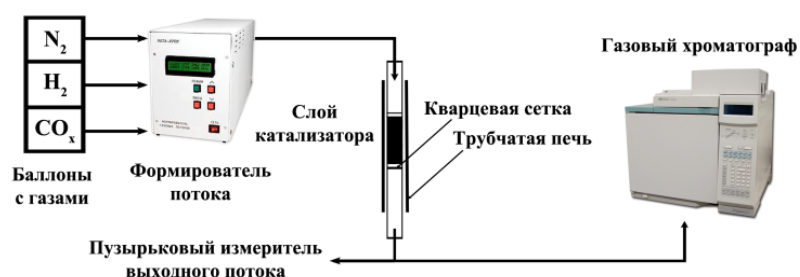
Рисунок 2 – Схема каталитической установки
