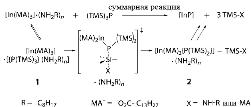
Рисунок 33 - Схема образования КТ InP, иллюстрирующая ингибирующее влияние амина [86]
