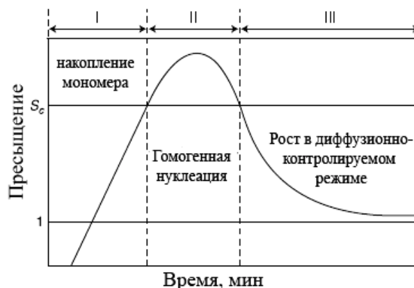
Рисунок 17 - Диаграмма ЛаМера: зависимость уровня пересыщения от времени
