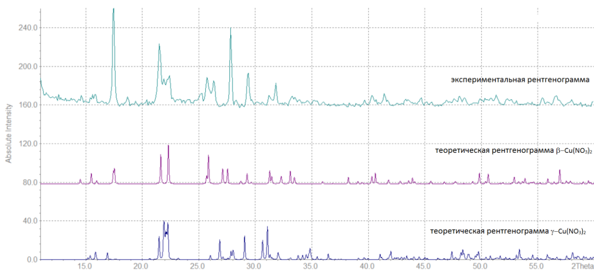
Рис.3.15 Сравнение дифрактограммы возгона полученного во втором опыте по получению безводного нитрата меди термическим разложением NO[Cu(NO_3)_3] с теоретическими рентгенограммами для \beta - Cu(NO_3)_2 и новой модификации \gamma - Cu(NO_3)_2 .
