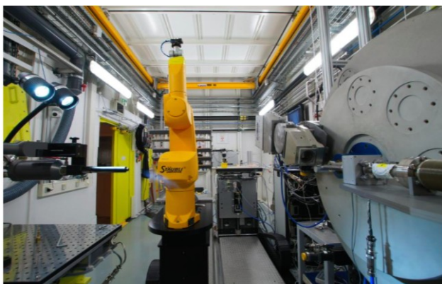
Рис. 19. Фотография рабочей установки ID22. Дифрактометр (справа), мобильный робот «рука» для смены образцов (посередине).
