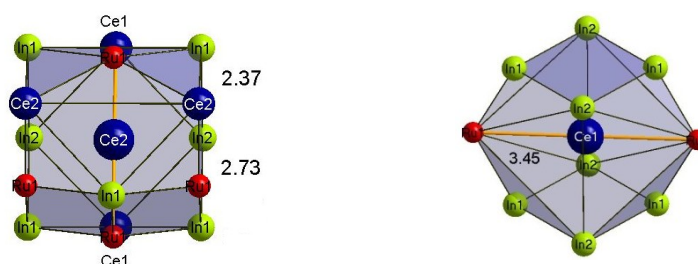
Рис. 90. Координационное окружение атомов Ce1, Ce2 в структуре Ce_3Ru_2In_3 : В координационном окружении атомов церия Ce2 присутствуют anomalно короткие и укороченные контакты Ce-Ru.
