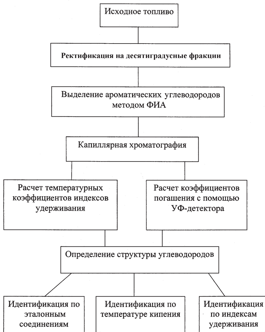
Рис. 5. Схема идентификации ароматических углеводородов реактивных топлив
