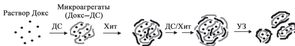
Рис. 2. Схема получения полиэлектролитных микрочастиц на комплексе (Докс–ДС) путем послойной адсорбции хитозана (Хит) и декстрансульфата (ДС) и воздействия ультразвука (УЗ)
