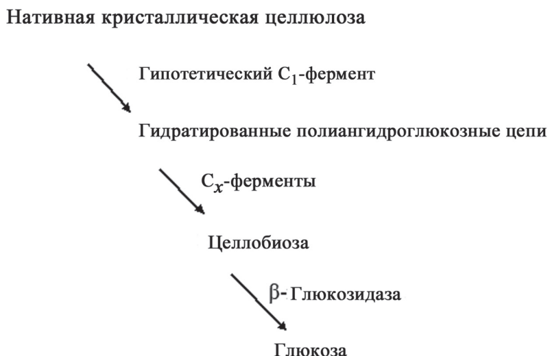
Рис. 1. Общая схема ферментативной конверсии целлюлозы [11]
