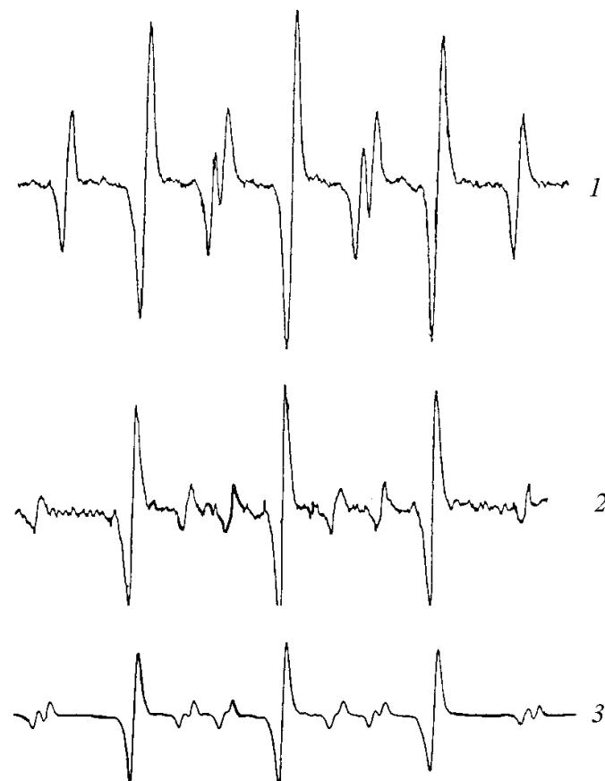
Спектры ЭПР растворов МНП в ДМБД при выдерживании образца в темноте, 20° С, 1 ч (1); при фотолизе МНП, 20° С (2); в присутствии стеарата кобальта и гидроперекиси кумила, 20° С (3)
